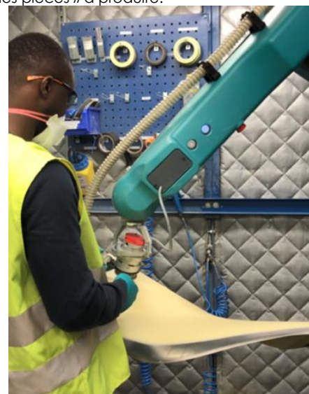
Fig.5 : essai du cobot de ponçage (Projet 7)
