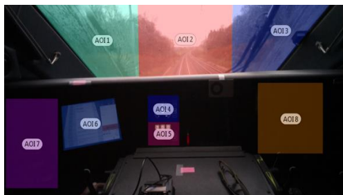
Figure 2. 8 aires d'intérêts (AOI) ont été étudiées (AOI 1-3 : vue extérieure ; AOI 4-8 : instruments en cabine)
