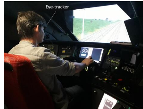
Figure 5. Illustration du dispositif expérimental en simulateur de conduite de TGV
